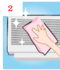
2 台所用中性洗剤を水で薄めた溶液で濡った布で、拭く。その後、水拭きして、から拭きする。
