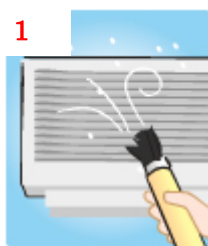
1 前面 パネルのホコリを掃除機で吸い取る。
