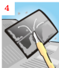
4 新聞などの上にフィルターを置いて、掃除機でホコリを吸い取る。
