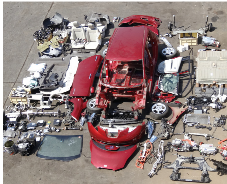
廃自動車のリサイクル(当研究室が行った解体調査の様子)
