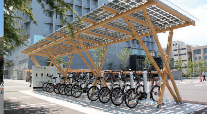
3. ES 総合館実験室のヤードを約 40m 目隠し、修景している。(県産杉) 4. 小径丸太を活用しソーラーパネル付きの駐輪場を設置。(県産杉) 5. ノーベル賞通り (仮) の車止めポールを設置。(県産杉) 6. 研究所共同館 I の天井および軒天井の 100 m 2 以上を木質化。(県産杉) 7. 学生施工により NIC の多世代共用スペース (100 m 2 ) を設置。(県産杉) 8. NIC のポスター掲示板 (可動式パネル約 30 枚) を製作。(県産杉)
