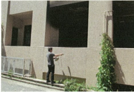
写真 9 外壁を直接法とスミア法にて測定(7/2)
