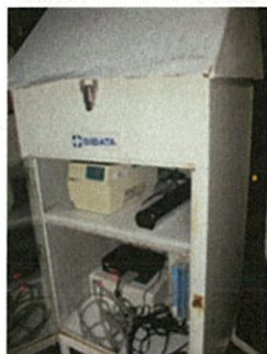
写真 13 実験室外側すぐの位置で空間線量の常時モニタリングを開始
